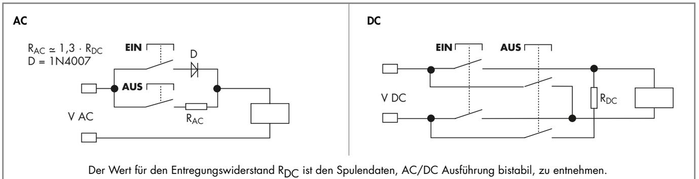
Bei Betätigung des EIN-Schalters erfolgt über die Diode eine Magnetisierung des Relais. Das Relais geht in die Arbeitsstellung und verbleibt in dieser Stellung auch nach Abschalten der Erregung. Bei Betätigung des AUS-Schalters wird über den Vorwiderstand das Relais entregt. Das Relais fällt in die Ausgangslage zurück.
